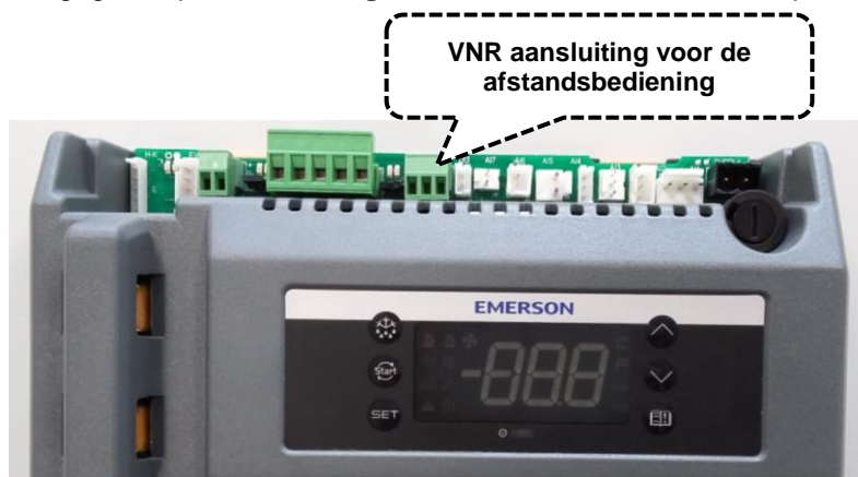
Figuur 15: VNR connectie voor de afstandsbediening
