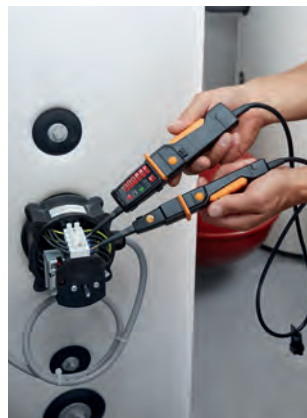
Spanning meten aan een boiler.
