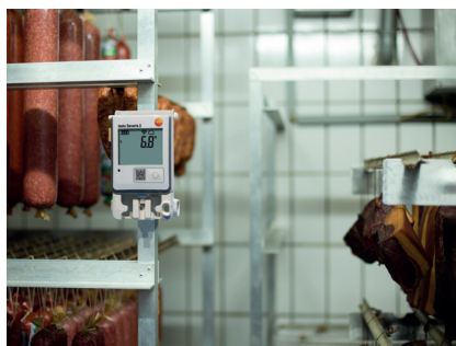
Koelruimte-bewaking bij de slager (testo Saveris 2-T2 met externe NTC-voeler met deurcontact)
