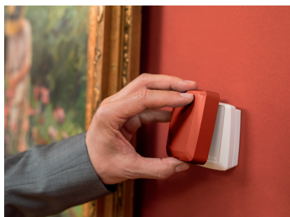
Visueel in omgeving geïntegreerde temperatuurmeting (testo 160 THL, THE, E met deco-cover)
