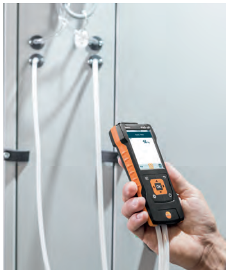
Met de testo 440 dP zijn metingen aan bijvoorbeeld klimaatinstallaties (verschilddruk over luchtfilter) snel uit te voeren.
