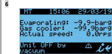
L'écran frontal affiche maintenant « Unité OFF par vide », le groupe de condensation ne pouvant être placé sur ON dans cet état. Répéter les étapes précédentes avant de charger le groupe en sélectionnant « Perform vacuum : NO » (générer le vide : NON)
